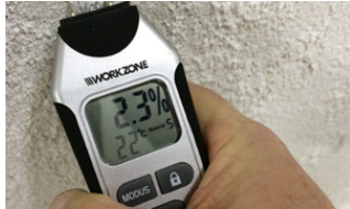
1. Expertizati excesul de umiditate si saruri
